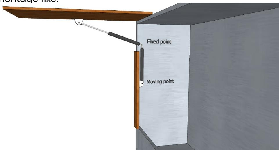
Le principal inconvénient de cette position de montage est le manque de contrôle de l'amortissement tout au long de la course. Au début de la course, l'huile est située en bas, du côté de la tige. Lorsque le couvercle s'ouvre, le ressort à gaz passe par sa position horizontale, ce qui fait que l'huile coule vers le bas, en direction de l'extrémité du tube.
