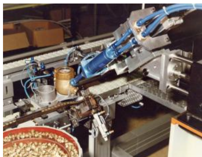
Poste de vissage de bouchons sur compteurs d'eau (moteur NF22424).
