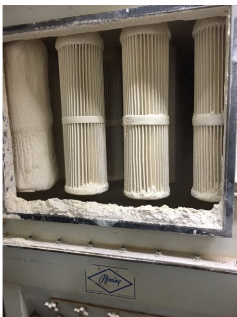
Filter links in beeld verzadigd met stof vóór het pulsen
