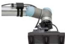
Aangepaste vacuümgrijper met in manifold gemonteerde venturi-vacuümpomp, 24 kg
